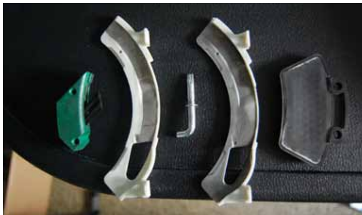
Элементы переоборудования: щетка регулируемая с ключиком, вставки на кукурузу и подсолнечник, подушка...
