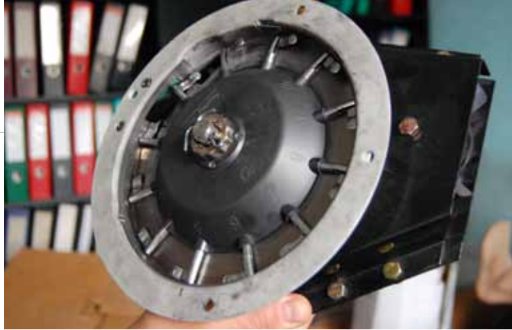
Переоборудованный пальчиковый высевальный аппарат
